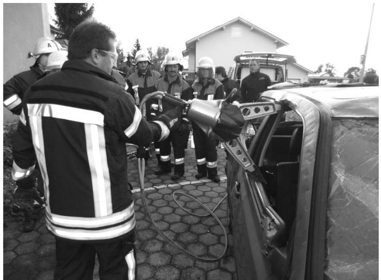
Statt des bisherigen Spreizers SP30 kommt inzwischen ein SP49 zum Einsatz. Außerdem wurde das alte Hydraulikaggregat durch ein neues ersetzt, das gleichzeitig auf beiden Leitungen arbeiten kann und auch zwei 20m Schnellangriffshaspeln mitbringt.
