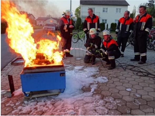
Daraufhin wurde dann die Brandwanne mit einem Benzin-Diesel-Gemisch entzündet, was angesichts der maßstäblich verkleinerten Schaumrohre einer brennenden Fläche von ca. 40 m<sup>2</sup> entspricht. Jedoch auch bei diesem Miniatureinsatz ist die Hitzeentwicklung bereits
